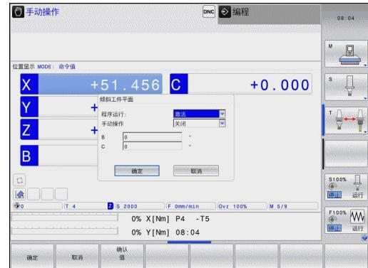
为复位倾斜功能，将菜单**Tilt working plane** ( 倾斜加工面 ) 中的所需操作模式设置为不可用。
