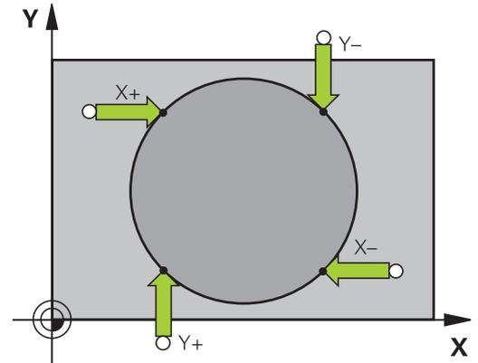
**使用多個鑽孔/圓筒立柱設定工件原點**
