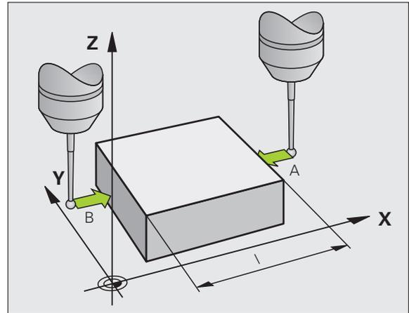
En la visualización del punto de referencia se tiene la distancia entre los dos puntos sobre el eje de coordenadas.
