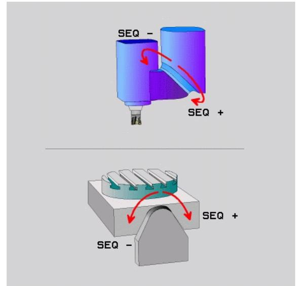
Ejemplo para una máquina con mesa giratoria C y mesa basculante A
