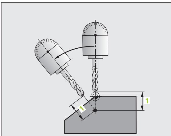
► Zvolte libovolnou funkci PLANE, definujte automatické natočení pomocí STAY. Při zpracování vypočte TNC hodnoty poloh rotačních os na vašem stroji a uloží je do systémových parametrů Q120 (osa A), Q121 (osa B) a Q122 (osa C)
