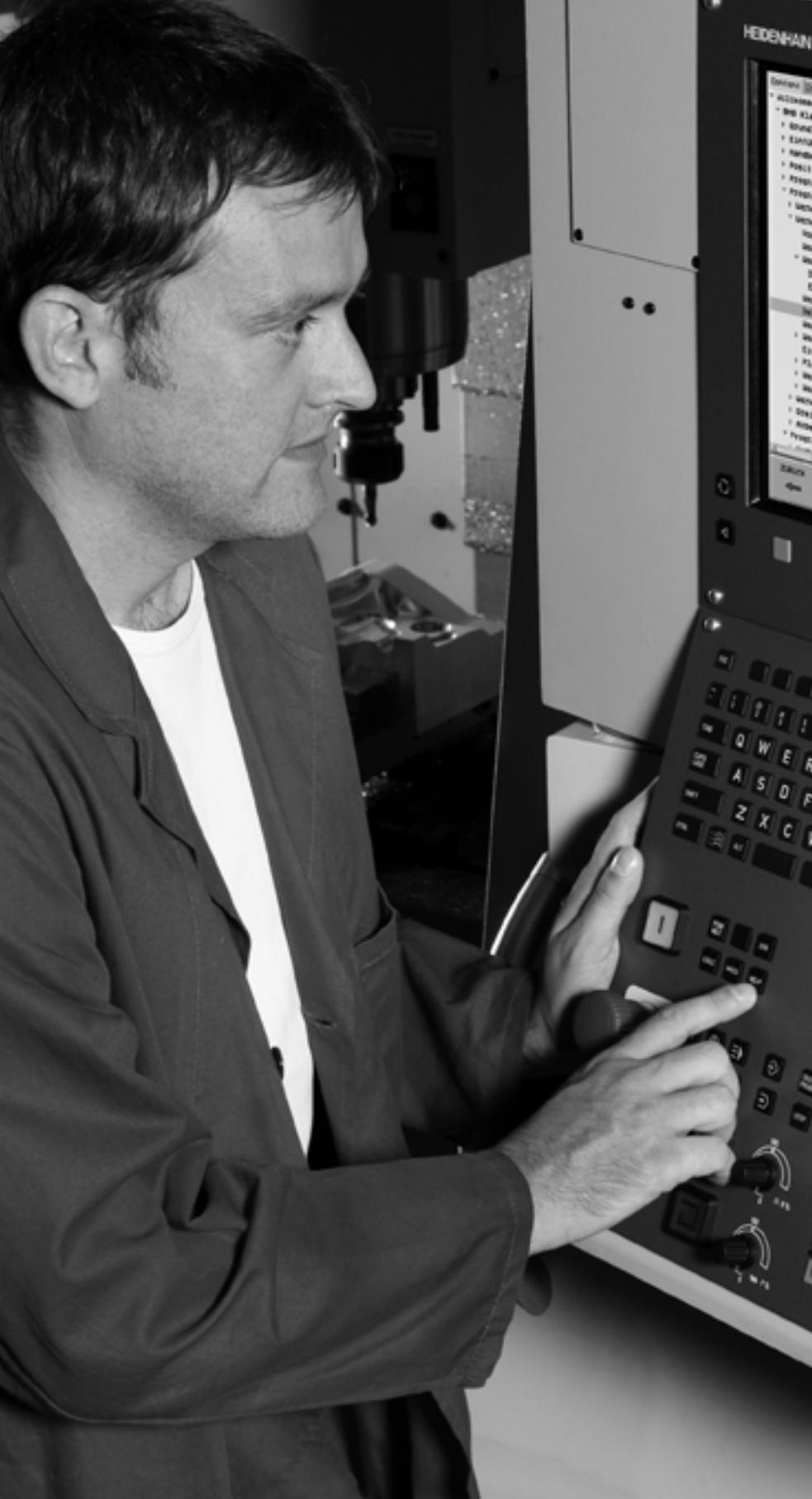
Systémy HEIDENHAIN TNC jsou souvislé řídicí systémy, jimiž můžete přímo na stroji v dílně naprogramovat obvyklé frézovací a vrtací operace pomocí snadno srozumitelného popisného dialogu. Jsou určeny pro nasazení na frézkách, vrtačkách a rovněž na obráběcích centrech s až 5 strojními osami. Navíc můžete programově nastavit úhlové natočení vřetena.
