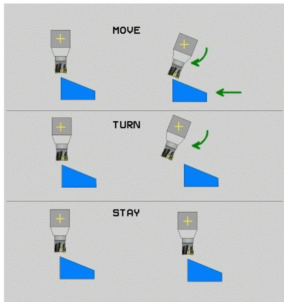
► Vzdálenost středu natáčení od hrotu nástroje (inkrementálně): TNC natáčí nástroj (stůl) okolo špičky nástroje. Pomocí parametru ABST přesunete střed natáčení, vztážený k aktuální poloze špičky nástroje.
