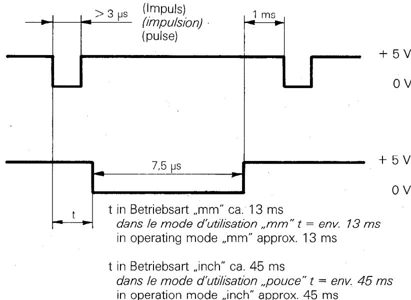
Der Einspeicherbefehl kann auch extern eingegeben werden (siehe 4.9.1). Der Einspeicherbefehl hat einen 7,5 µs breiten Druckerauslöse-Impuls zur Folge, dessen Vorderflanke um t ms gegenüber dem Einspeicherbefehl verzögert ist. Mit diesem Impuls kann der Folgeelektronik (Drucker, Rechner usw.) die Datenbereitschaft gemeldet werden.
