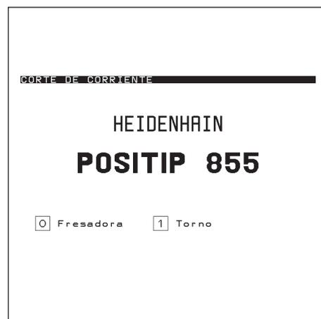
Fig. 37: Pantalla del POSITIP después de la primera conexión
