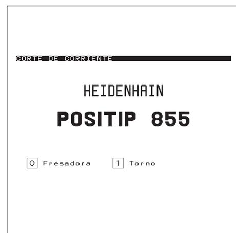
Fig. 34: Pantalla del POSITIP después de su primera conexión
