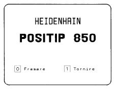
Premendo il tasto 1 si imposta il programma per "Tornire" protetto contro cadute di rete. Successivamente è possibile modificare tale impostazione soltanto mediante il parametro P99.0 "Fresare, Tornire" (vedi "Parametri", paragrafo 4.2).
