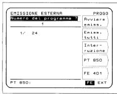
Esempio: nel modo operativo PROGO è selezionata la funzione EMISSIONE ESTERNA. Il protocollo di trasmissione dati è impostato per FE 401: Visualizzazione FE
