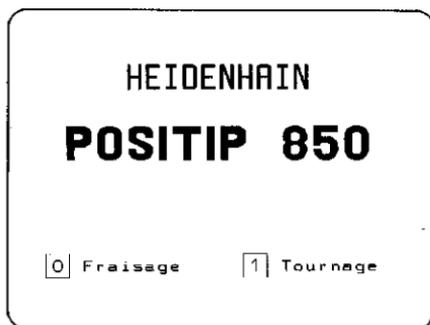
En appuyant sur la touche **1**, le programme "tournage" est protégé en mémorisation. Toute nouvelle modification permettant de retourner au mode d'utilisation "fraisage" ne peut être effectuée qu'au moyen du paramètre P 99.0 "Fraisage, Tournage" (cf. Paramètres, paragr. 4.2).
