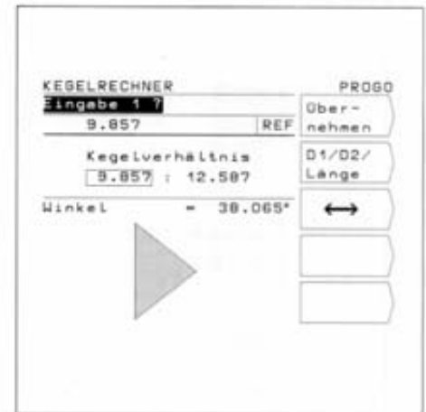
Bild 29: Kegelwinkel berechnen aus dem Kegelverhältnis
