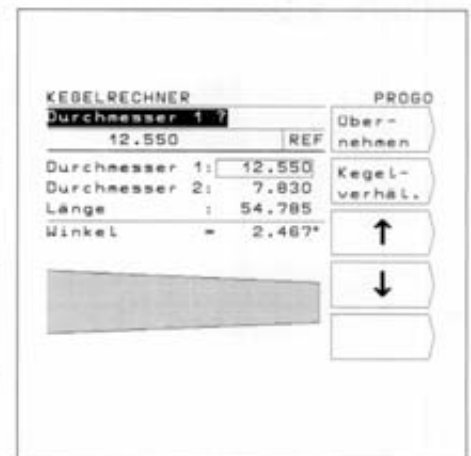
Bild 29: Kegelwinkel berechnen aus den Durchmessern und der Länge des Kegels
