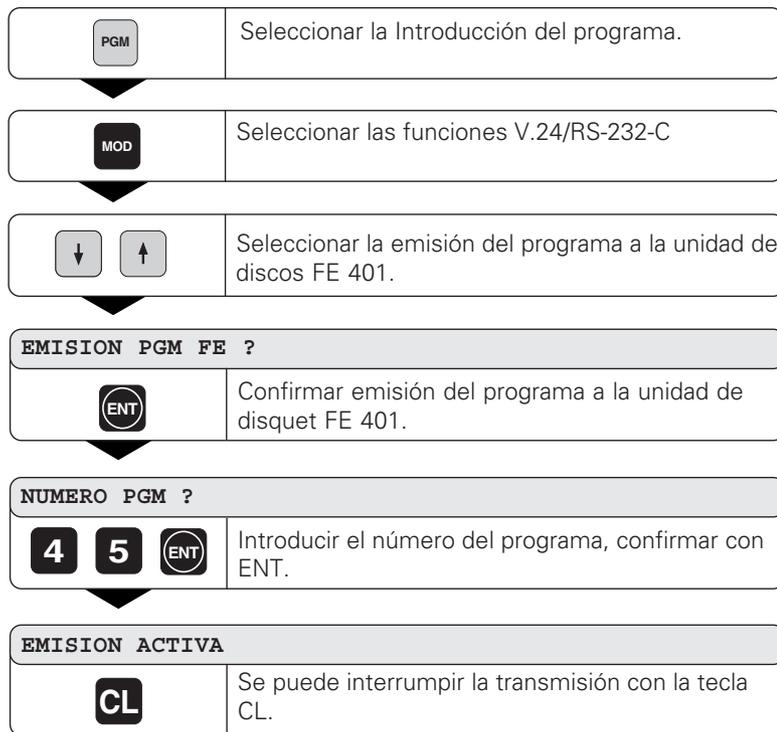
La transmisión del programa puede realizarse a la unidad de discos FE 401, a un PC o a una impresora.
