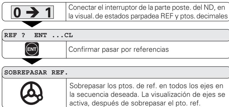
Una vez sobrepasados los puntos de referencia, se memorizan todos los puntos de referencia (99 por eje), quedando protegidos contra fallos de tensión los últimos valores determinados entre el cero de la pieza y la referencia de los ejes.
