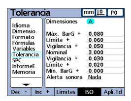
Fijar rango de tolerancia por encima del valor nominal (tolerancia +)
