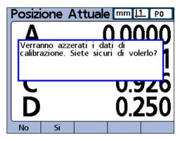
► Con Softkey Si, confirmar el borrado de la calibración de pieza
