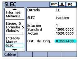
Cuando el proceso ha concluido y los datos se han introducido, se calcula un coeficiente de compensación para el sistema de medición.
