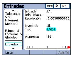
Si para un transductor se ha calibrado la amplificación y se ha realizado el ajuste del cero en la superficie de referencia teórica, la resolución del transductor se puede calibrar con la función Set. El sistema de medición está entonces listo para medir.
