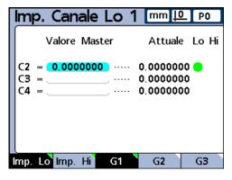
Fijar el punto de referencia para la medición (Calibrar).
