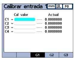
Si en el menú de Setup Calibrar se ha configurado que se realicen calibraciones completas de las entradas de un detector de medición (ajustado **Permitir calibr. completas** a **Min-Máx.**), en todo momento se puede calibrar para cada entrada el rango de medición completo mediante los submenús Cal Entrada bajo (Kanal auf Lo) y Cal Entrada alto (Kanal auf Hi).
