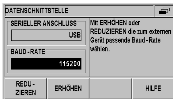
Abb. II.35 Datenschnittstelle USB (UART)
