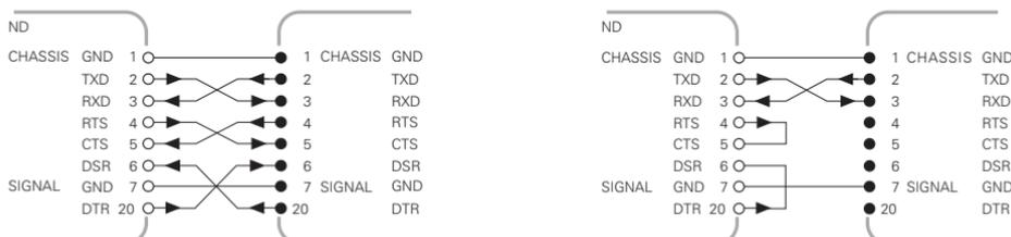
**CHASSIS GND:** massa chassis, **TXD:** dati di trasmissione, **RXD:** dati di ricezione, **RTS:** richiesta di trasmissione, **CTS:** pronto alla trasmissione, **DSR:** unità di trasmissione pronta, **SIGNAL GND:** massa segnali, **DTR:** terminale dati pronto
