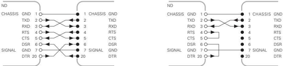
**CHASSIS GND:** Gehäusemasse, **TXD:** Sendedaten, **RXD:** Empfangsdaten, **RTS:** Sendeaufforderung, **CTS:** Bereit zum Senden, **DSR:** Übermittlungseinheit bereit, **SIGNAL GND:** Signalmasse, **DTR:** Datenendgerät bereit
