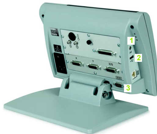
Abb. 2.6 Разъем для наушников, USB и RS-232 разъемы
