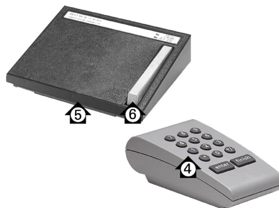
Abb. 2.17 Dálkové klávesy a spínače dostupné pro přiřazení klávesových zkratk
