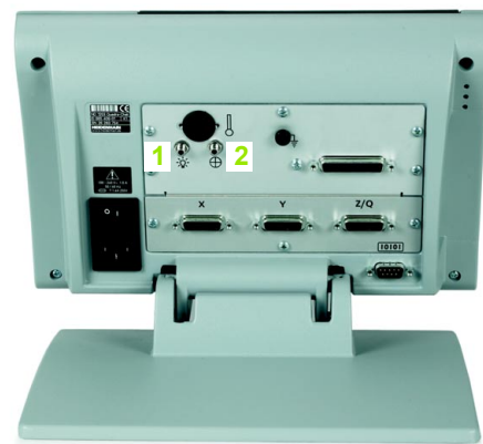
Abb. 2.9 Vstupy reference a kabelu od senzoru
