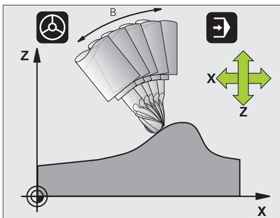
За M128 можно ввести еще одну подачу, на которой ЧПУ выполнит компенсационные перемещения по линейным осям. Если подача не введена или превышает установленную в машинном параметре 7471, действует подача из параметра 7471.
