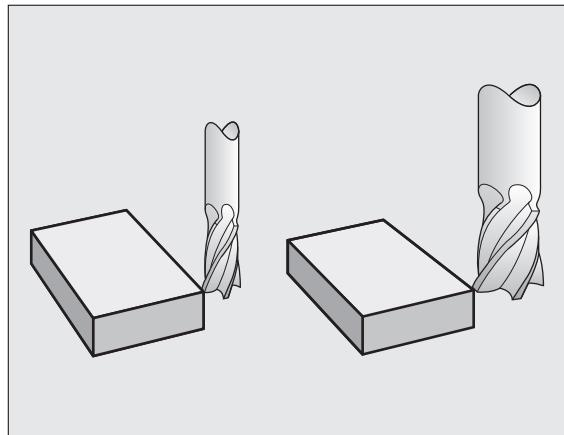
При поправке на длину учитываются как дельта-значения из T-кадра, так и дельта-значения из таблицы инструмента.
