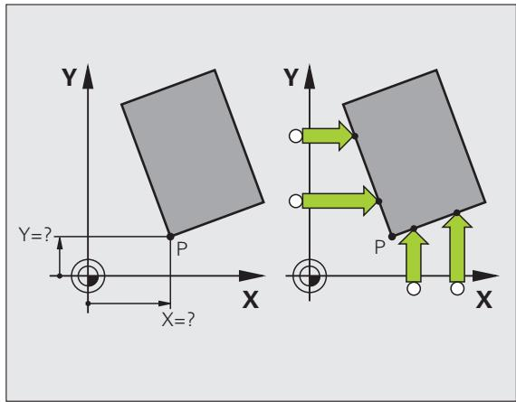
**Угол в качестве точки привязки – не принимать точки, ощупывание которых будет выполнятьсь для разворота плоскости обработки**
