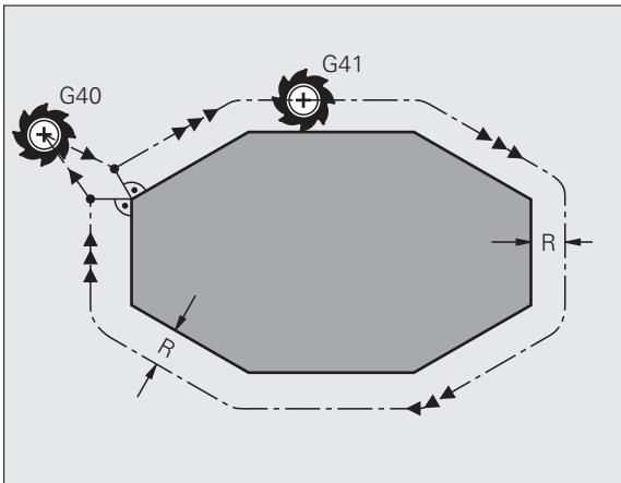
При поправке на радиус система ЧПУ учитывает как дельта-значения из кадра T, так и дельта-значения из таблицы инструментов.
