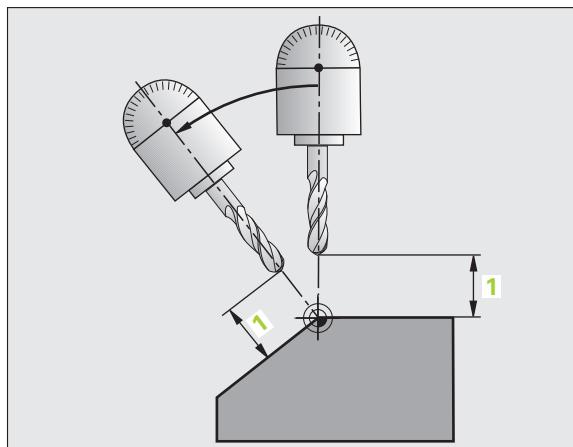
► **Подача? F=:** скорость движения по траектории, с которой инструмент должен поворачиваться
