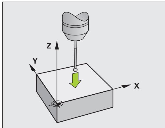
**Угол в качестве точки привязки – скопировать точки, ощупывание которых будет выполняться для разворота плоскости обработки**
