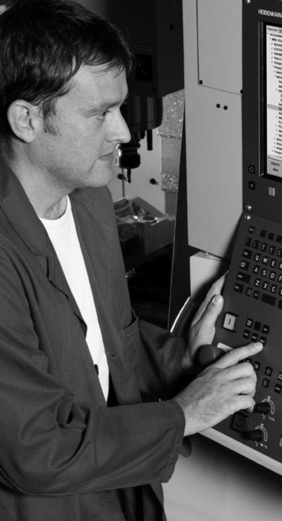
Системы ЧПУ фирмы HEIDENHAIN - это системы управления, ориентированные на работу в цехе, с помощью которых можно простым, доступным способом программировать стандартные типы обработки в диалоге открытым текстом непосредственно на станке. Они предназначены для применения на фрезерных и сверлильных станках, а также в обрабатывающих центрах. iTNC 530 может управлять 18 осями. Дополнительно при программировании можно настраивать угловое положение до 2 шпинделей.
