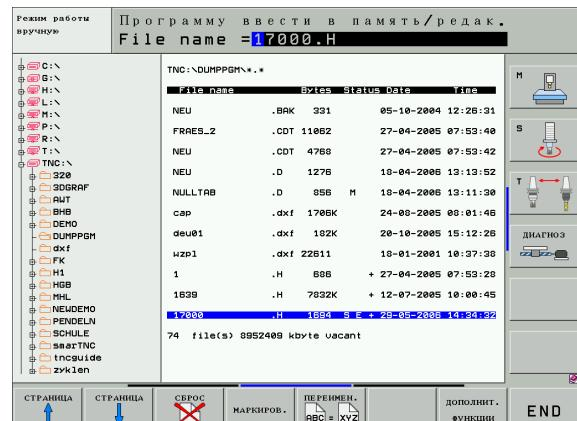
Чтобы установить связь с сетью, может потребоваться некоторое время. Затем система ЧПУ отображает справа вверху на дисплее [READ DIR]. Максимальная скорость передачи составляет от 2 до 5 Мбит/с в зависимости от типа передаваемого файла и нагрузки на сеть.
