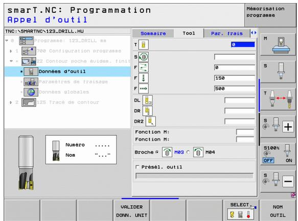
Autres paramètres dans le formulaire détaillé **Paramètres de fraisage**:
