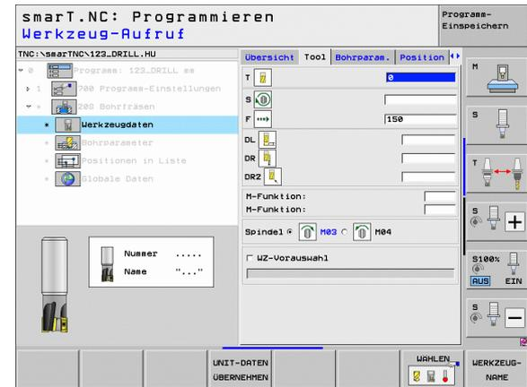
Zusätzliche Parameter im Detailformular **Bohrparameter:**
