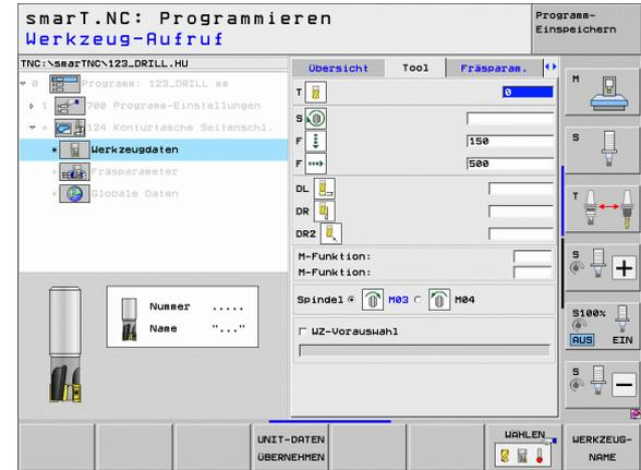
Zusätzliche Parameter im Detailformular **Fräsparameter:**
