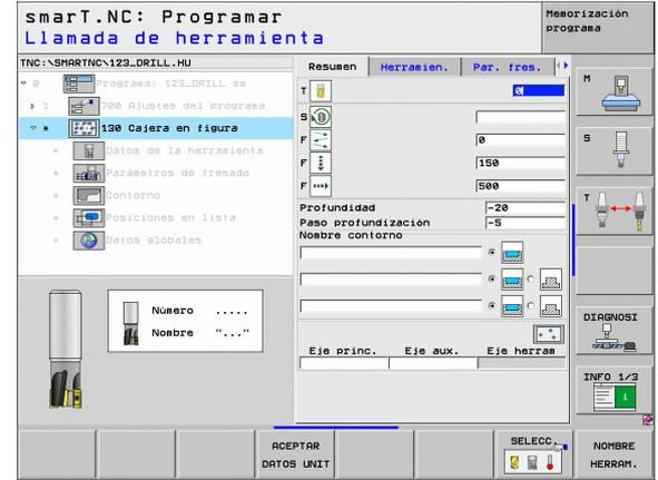
► **Posiciones o figuras de puntos:** definir posiciones, sobre las cuales el TNC debe ejecutar la cajera de contorno (véase "Definición de posiciones de mecanizado" en pág. 145.)
