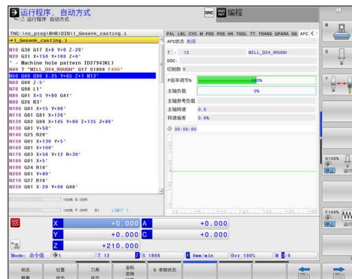
自适应进给控制功能使数控系统在NC程序运行期间按照当时的主轴功率自动控制进给速率。该数控系统在信息获取中确定的各加工步骤需要的主轴功率并将其保存在属于NC程序的文件中。每一个加工步骤开始时，通常是启动主轴旋转时，数控系统控制进给速率使其保持在定义的限制速度范围内。
