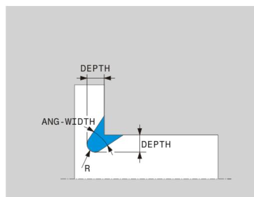
**UDC TYPE\_U底切****底切 UDC TYPE\_U的输入参数**
