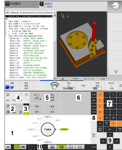
测试运行操作模式下的操作面板
