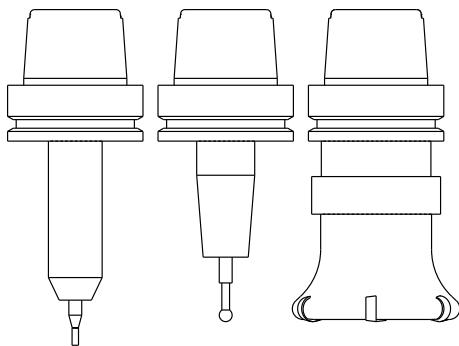
根据刀具表中的数据，刀具坐标系的坐标原点平移到刀具中心点TCP。TCP表示Tool Center Point（刀具中心点）。
