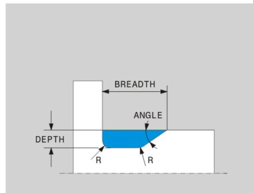
**DIN 509 UDC TYPE\_F底切****底切DIN 509 UDC TYPE\_F的输入参数**
