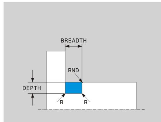
**UDC THREAD底切****底切DIN 76 UDC THREAD的输入参数**
