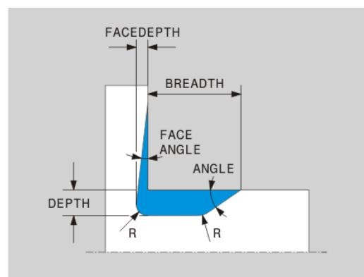
**DIN 509 UDC TYPE\_H底切****底切DIN 509 UDC TYPE\_H的输入参数**
