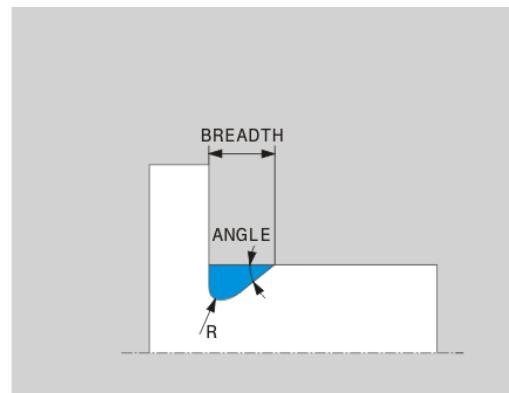
**UDC TYPE\_K底切****底切 UDC TYPE\_K的输入参数**
