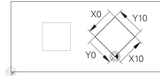
基于输入坐标系原点的轮廓可轻松根据需要变换。
