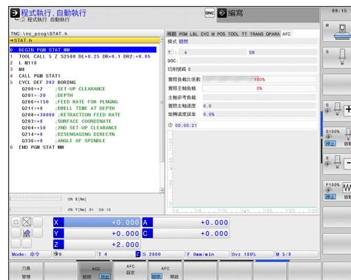
在可適化進給控制中，TNC於程式執行期間自動控制進給速率，做為目前主軸功率消耗的功能。每次加工步驟所需要的主軸功率在教學切削時會被記錄，並由TNC儲存在屬於加工程式的一個檔案當中。當開始每次的加工步驟時，當主軸開啟時，TNC通常會控制進給速率，如此仍可保持在您所定義的極限內。
