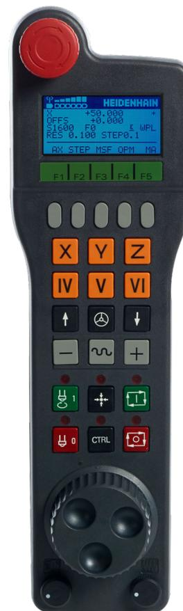
Si plusieurs manivelles sont raccordées à la CN, la touche de manivelle qui se trouve sur le panneau de commande ne sera pas disponible. La manivelles s'active/se désactive avec la touche de manivelle qui se trouve sur la manivelle. Pour pouvoir sélectionner une autre manivelle, la manivelle actuellement active doit d'abord être désactivée.
