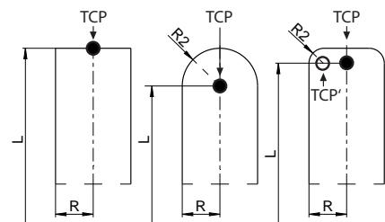
若啟動雜項功能**M128**，刀具座標系統的方位取決於目前刀具的傾斜角度。
