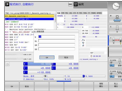
在所有操作模式內(除了編寫模式以外)的額外狀態顯示中可顯示Q參數。
