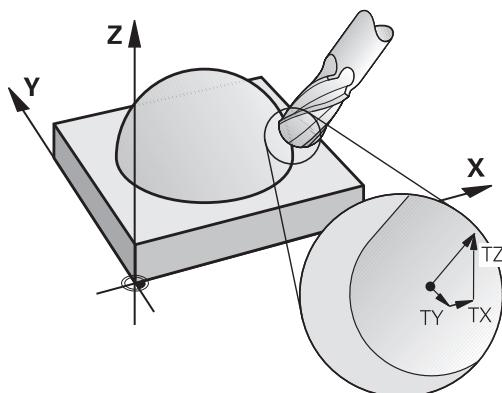
如果在**LN**單節未定義刀具定向，並且已啟動**TCPM**時，控制器維持刀具垂直於工件輪廓。
