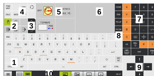
Nadzorna plošča načina delovanja Ročno delovanje
