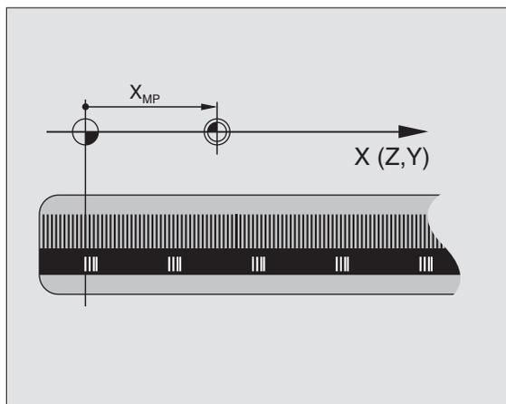
El constructor de la máquina introduce para cada eje la distancia desde el punto cero de la máquina al punto cero de la regla en un parámetro de máquina.
