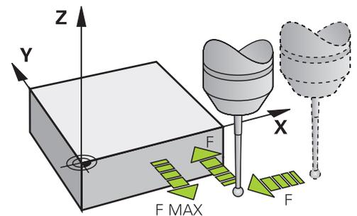
Wenn die Steuerung einen Tastsystemzyklus abarbeitet, fährt das 3D-Tastsystem achsparallel auf das Werkstück zu (auch bei aktiver Grunddrehung und bei geschwenkter Bearbeitungsebene). Der Maschinenhersteller legt den Antastvorschub in einem Maschinenparameter fest.
