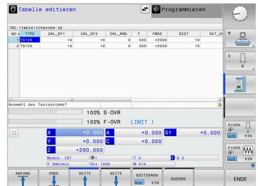
**i** Stellen Sie sicher, dass die Werkzeugnummer der Werkzeugtabelle und die Tastsystemnummer der Tastsystemtabelle zusammenpassen. Dies gilt unabhängig davon, ob Sie einen Tastsystemzyklus im Automatikbetrieb oder in der Betriebsart **Manueller Betrieb** abarbeiten wollen.
