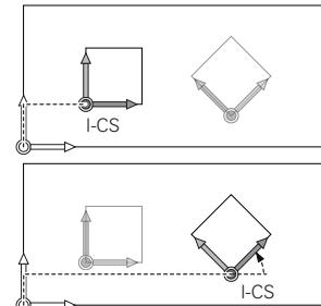
用输入坐标系的定位程序段，用户可以定义刀具位置，因此能确定刀具坐标系的位置。
