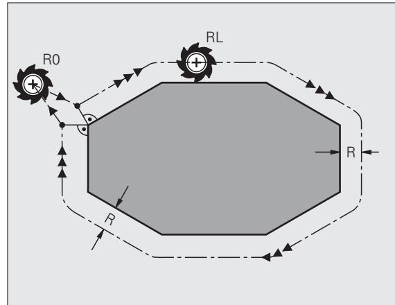
对刀具半径补偿而言，TNC 系统使用的差值考虑 **TOOL CALL**（刀具调用）程序段和刀具表两方面因素：
