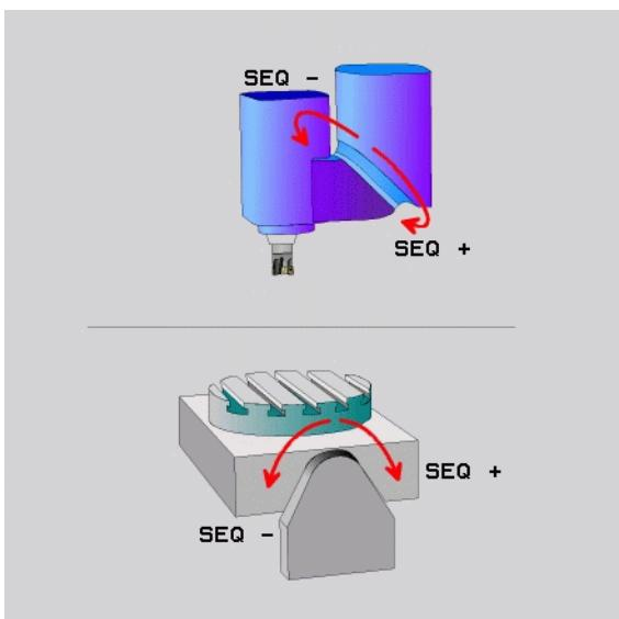
举例，C 轴回转工作台和 A 轴倾斜工作台的机床。编程功能：
