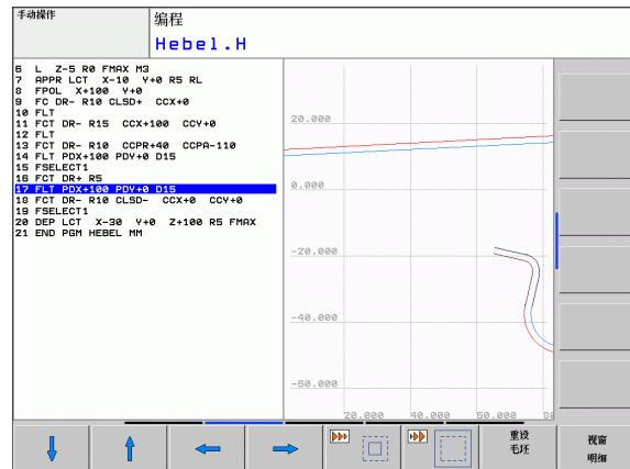
用 RESET WORKPIECE BLANK (复位工件毛坯) 软键恢复原来的選擇范围。
