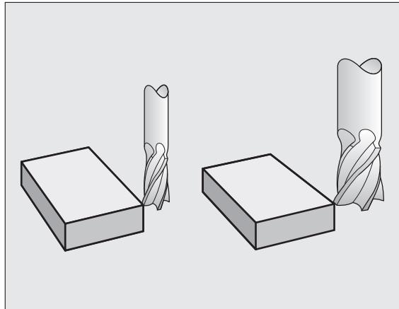
对刀具长度补偿而言，数控系统使用的差值考虑 **TOOL CALL**（刀具调用）程序段和刀具表两方面因素：
