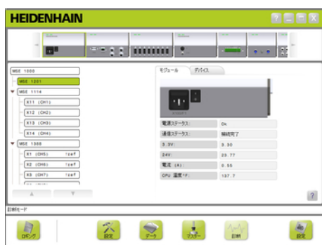
電源モジュール診断画面
